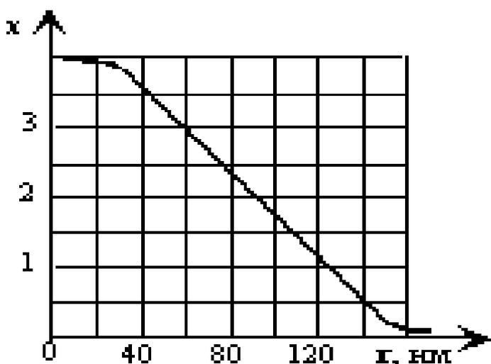
Вычерчивают график зависимости  $\lg D$  от  $\lg \lambda$  и по тангенсу углу наклона полученной прямой определяют  $x$ , а затем по рисунку 5 - средний размер частиц.
